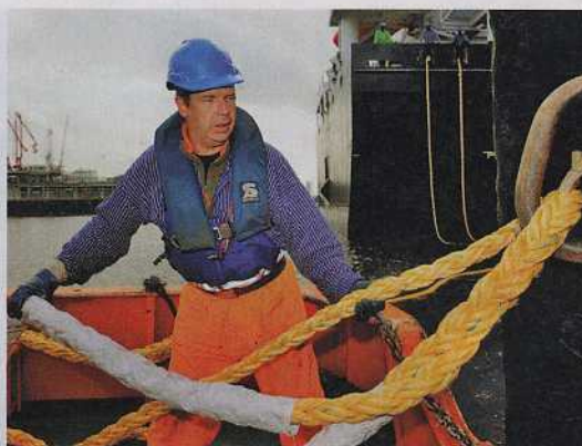
Dierk zieht ein Trossenauge (die Schlaufe) der „Chiberta“ durch einen Stahlring am Dalben
